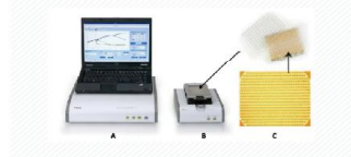
图 1. RTCA 实时无标记细胞功能分析仪。(A) 分析仪 (B) 检测台；(C) E-Plate 检测板及微电极阻抗传感器阵列。
